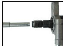
Insérez le point de centrage pour que les encoches dans le point de centrage s'accrochent aux prises de la broche.
