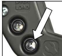
Zusätzlich befindet sich auf am Schaltergriff eine Serviceanzeige, welche das bevorstehende Abschalten der Maschine aufgrund abgenutzter Kohlebürsten rechtzeitig anzeigen kann. Nach Aufleuchten der Anzeige kann noch ca. 1 Tag gearbeitet werden. Dann sollten die Kohlebürsten ersetzt werden.
