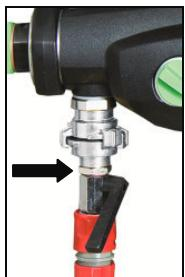
Placez l'adaptateur avec la valve à bille sur le connecteur de l'outil et tournez dans le sens de la flèche jusqu'à l'arrêt. Branchez l'outil au réseau d'eau ou à un réservoir sous pression en utilisant le mamelon bien ajusté.
