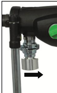
Beim Arbeiten entstehender Staub ist gesundheitsschädlich. Bei Trockenbohrungen ist deshalb ein Staubsauger zu verwenden und eine Staubschutzmaske zu tragen. Setzen Sie den Adapter für die Staubabsaugung auf den Anschluss der Maschine und drehen Sie ihn in Pfeilrichtung gegen den Anschlag. Der passende Nass-Trocken-Sauger DSS 25 A ist als Zubehör erhältlich. Die Verwendung einer Absaugung ist ebenfalls Voraussetzung für eine optimale Schnittleistung der Bohrkrone (Luftkühlung).
